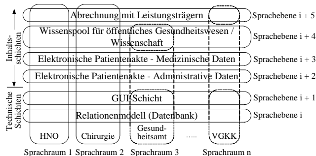
Fig. 3. Sprachebenen und Sprachräume zur Bestimmung einer Architektur der elektronischen Patientenakte
